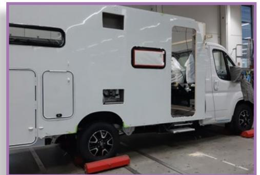
installiert werden. Dann erfolgt der Einbau der Seitenwände, um dann die Möbel auszurichten und zu befestigen. Zuvor werden sie mit den Fenstern bestückt und die Dekorfolie sorgfältig angebracht. An der nächsten Station sind hauptsächlich Schreiner und Holzmechaniker beschäftigt, die die Möbel einbauen. Jedes Holzteil, ob Latte oder Plattenmaterial, wird bei Hobby selbst zugeschnitten und vorbereitet. Beim nächsten
